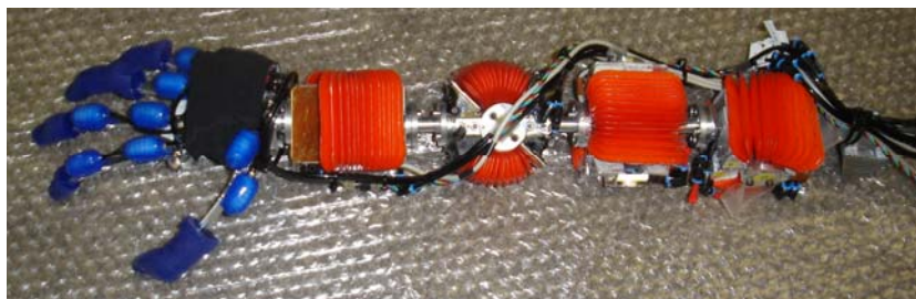
Abbildung 5: Roboterarms „PRMA4“ mit dem 5-Finger-Softgreifer „APH8“
