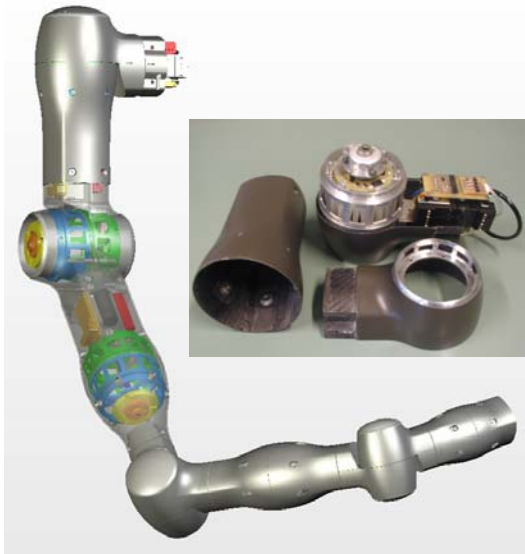
Abbildung 4: Der hydraulisch betätigte Oberarm
